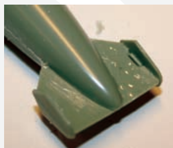
Obr. 8A Zatečené lepidlo
