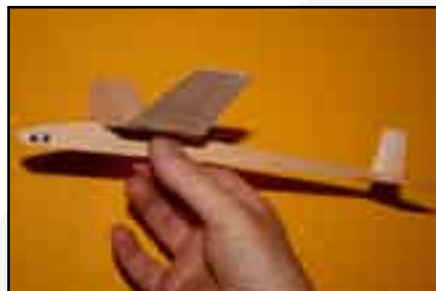
Obr. 28. – Model těžký na ocas
