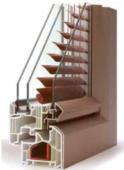
Obr. 3: Letní pohoda je velmi důležitá u bytových domů, proto se používají různé systémy stínění. Zabudované žaluzie mezi zasklením představují účinné zastínění i ochranu proti větru. (Zdroj Internorm)
