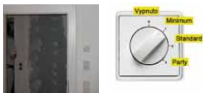
Obr. 3: Viditelné jsou jen vyústky nad dveřmi přivádějící vzduch. Nesmírně důležitá je jednoduchost regulace. Nejvhodnější je srozumitelný třípolohový ovladač. (Zdroj CPD)
