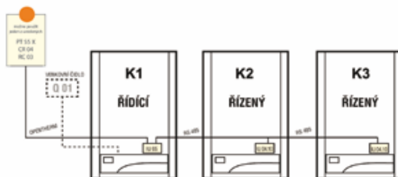
Obr. 3: Řízení s nadřazeným regulátorem s venkovním čidlem (ekvitemní regulace)
