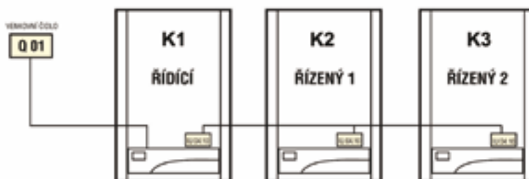
Obr. 5: Regulace pouze podle venkovní teploty
