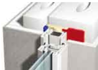
Rekonstrukce – zalomené ostění se zateplenou fasádou
