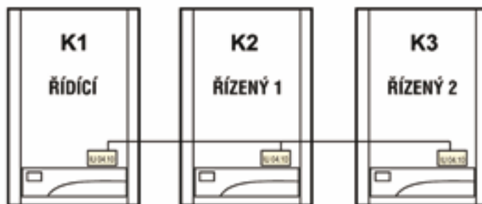
Obr. 4: Regulace na konstantní teplotu bez nadřazeného regulátoru
