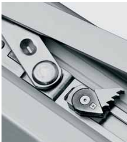
obr. 4 - „hřebínek“ v horních nůžkách okenního kování activPilot umožňuje při čtvrté poloze kliky jemnou regulaci sklopení okna - větrání, tzv. více-polohové větrání
